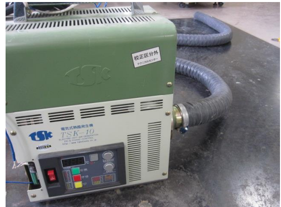
【Hot Air Generator】
